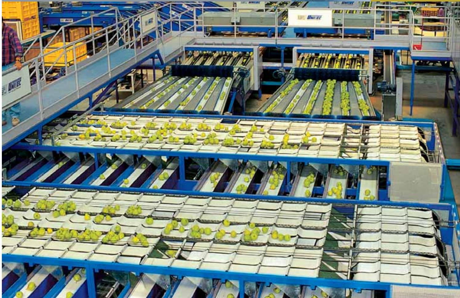
Transportador inteligente a rodillos tipo "INTELL-A-VEYOR", posicionamiento de los frutos con transportador continuo, descarga delicada sobre cortina tipo "DROP-CARTING" con función especial "inteligente" de **reconocimiento y descarga en relación a la dimensión del fruto**.
