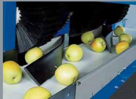
➤ Detalle del sistema de descarga Unical\_600 S tipo "SOFT-CARTING".
