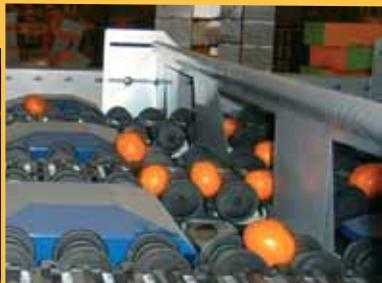
➤ Detalle del sistema de descarga Unical\_600 T tipo "DROP-CARTING".
