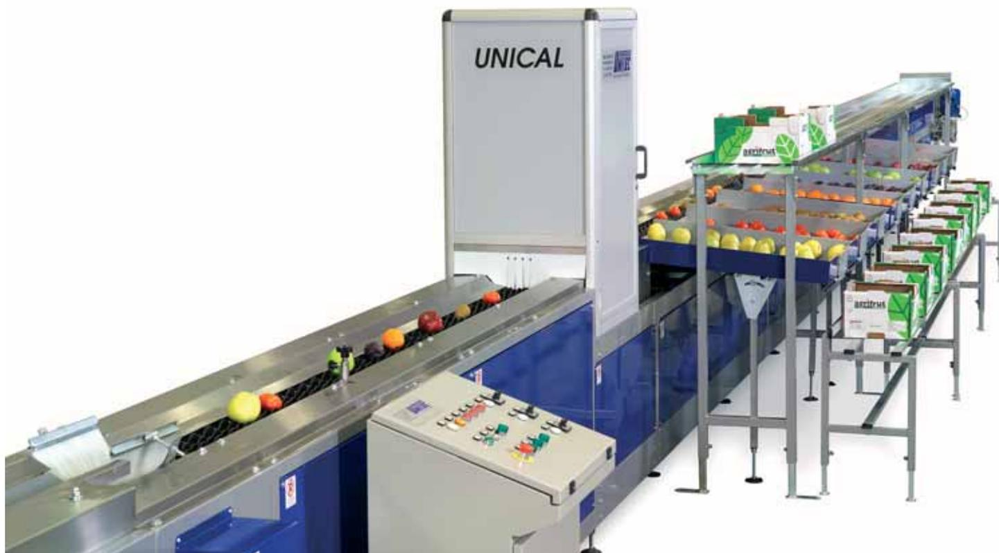
UNICAL\_600 MONO tiene un sistema de transporte inteligente a rodillos tipo, "INTELL-A-VEYOR" **paso alojamiento de frutos 89 mm** y la posibilidad de descargar muy delicadamente y directamente en la mesa de confección o en cintas transportadoras motorizadas.
